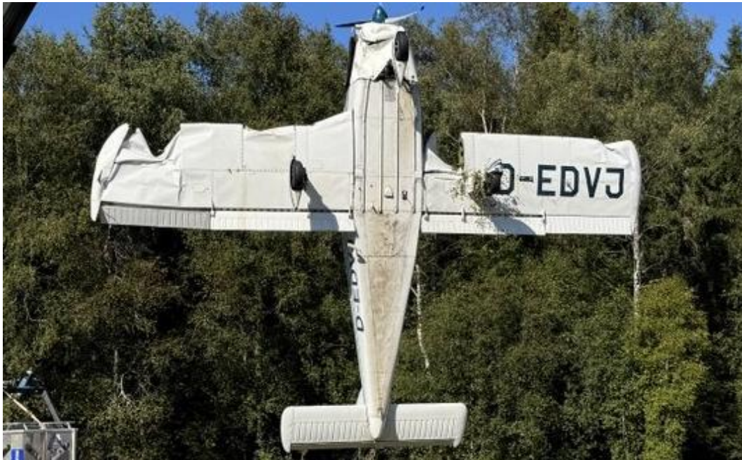
Figur 2. Skadorna på vingarna och främre delen av kroppen syns. Bilden är tagen i samband med bärgningen av flygplanet.
