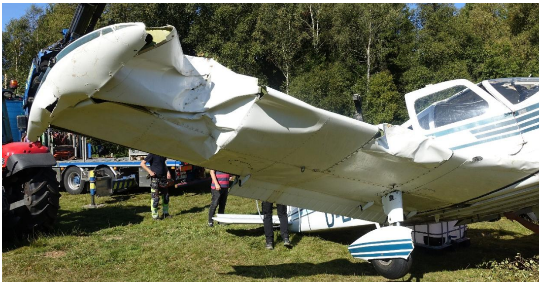
Figur 9. Skador på höger vinge.
