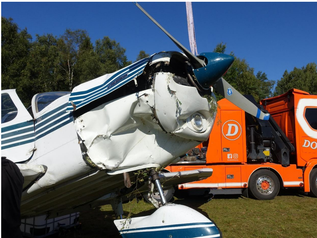
Figur 11. Skador framför brandskottet.
