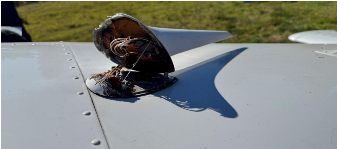
Figur 4. Bild på den avbrutna kommunikationsantennen.
