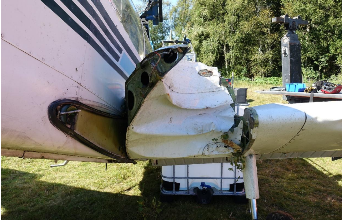
Figur 10. Skador på vänster vingrot.
