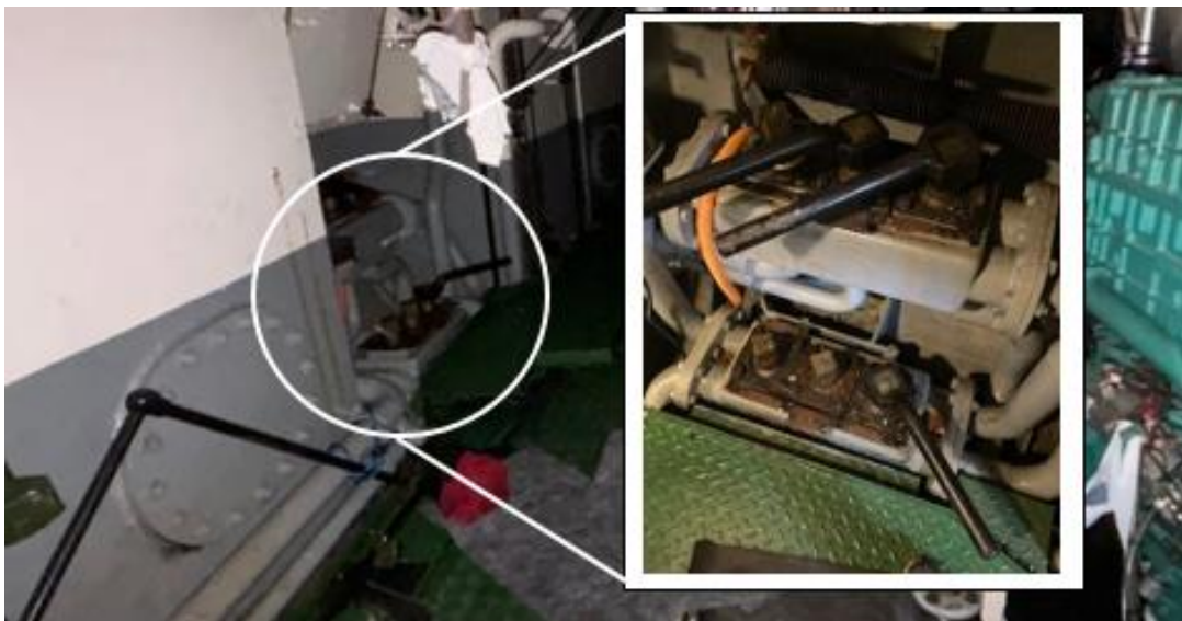
Figur 14. Bilden visar länslådan bestående av två rader med tre ventiler i varje. Dessa är kopplade till flera olika rörsystem. Bild: Klaravik och Transportstyrelsen (inklippet bilden). Markeringar införda av SHK.
