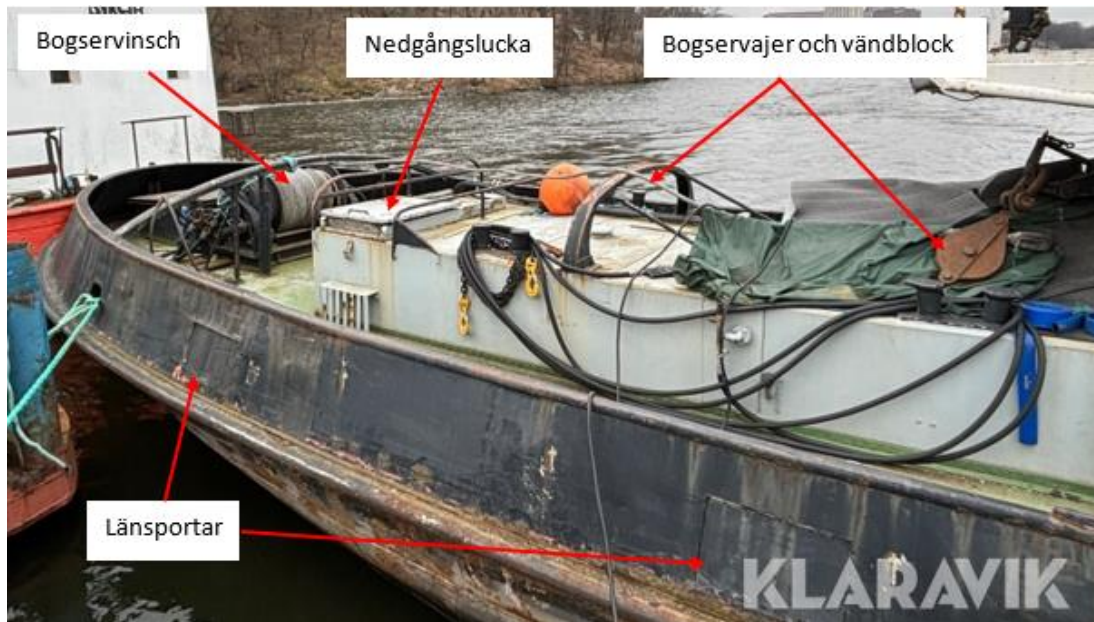
Figur 11. Akterdäcket på fartyget där bland annat nedgångsluckan och bogservajern visas. Bild: Klaravik. Markeringar införda av SHK.
