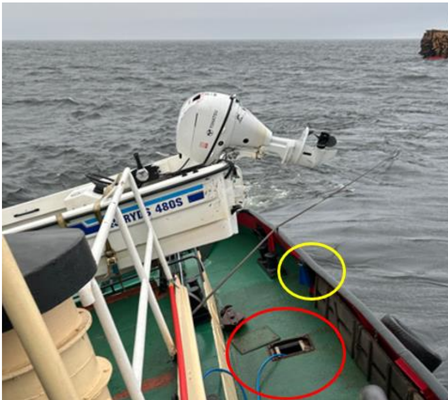
Figur 5. Röd markering visar den öppna manluckan till babords barlasttank med en blå pump-slang i. Den gula markeringen visar svanhalsen till samma tank. I övre högra hörnet syns pråmen som var kopplad till fartyget med bogservajern som löper ut över babords reling. Bild tagen av besättningen kl. 04.47. Bild: Rederiet. Markering infogad av SHK.
