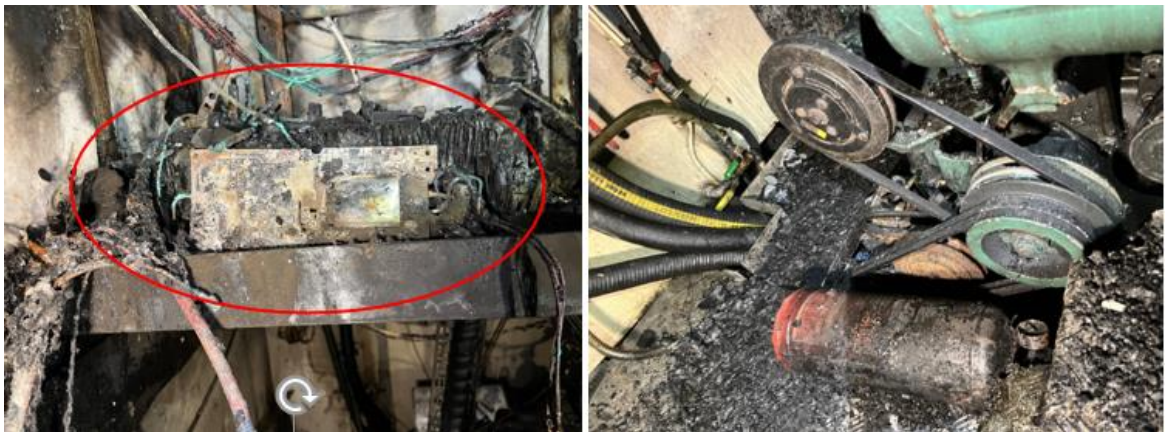
Figur 4. Vänstra bilden visar rester av startbatteriet och batteriladdaren (av SHK rödmarkerad). De var placerade strax under taket i det aktra styrbordshörnet av maskinrummet. Högra bilden visar kilremmar på huvudmotorn belägna vid durken i den förliga delen av maskinrummet samt handbrandsläckaren som fallit ner från sitt fäste på maskinrumstegen.
