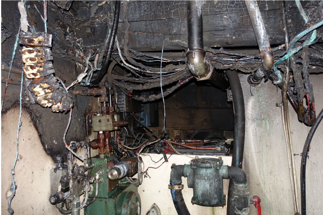
Foto 7. Brandmönstret på främre maskinrums skottet till höger i bilden, mitten av bilden styrbords maskinrums skott.
