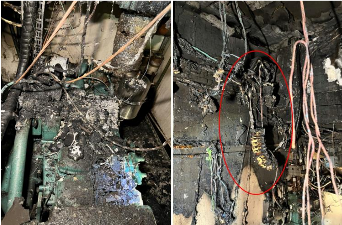
Figur 5. Vänstra bilden visar huvudmotorn ovan- och förifrån. Väggbeklädnaden kring motorn är opåverkad av branden liksom färgen på huvudmotorn. Högra bilden visar styrbords förliga maskinrumsskott och resterna av en säkringscentral (av SHK rödmarkerad), som blivit kraftigt påverkad av branden.
