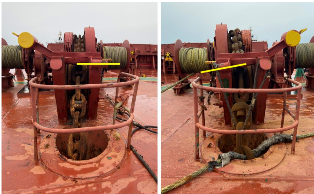
Figur 6. Ankarspelen sedda förifrån. Styrbords ankarspel (vänstra bilden) användes och kättingen var säkrad med broms och kättingstoppare. På babords ankarspel (högra bilden) kunde man se att kättingen inte passade ihop med kättinghjulet. Kättingen klättrade över kättinghjulet. Den ena av de två hållarna för säkringsvajern var också något nedböjd, jämför de gula inritade strecken. Förtöjningstrossen som går igenom ankarkättingen var anbringad som ett extra skydd efter händelsen.
