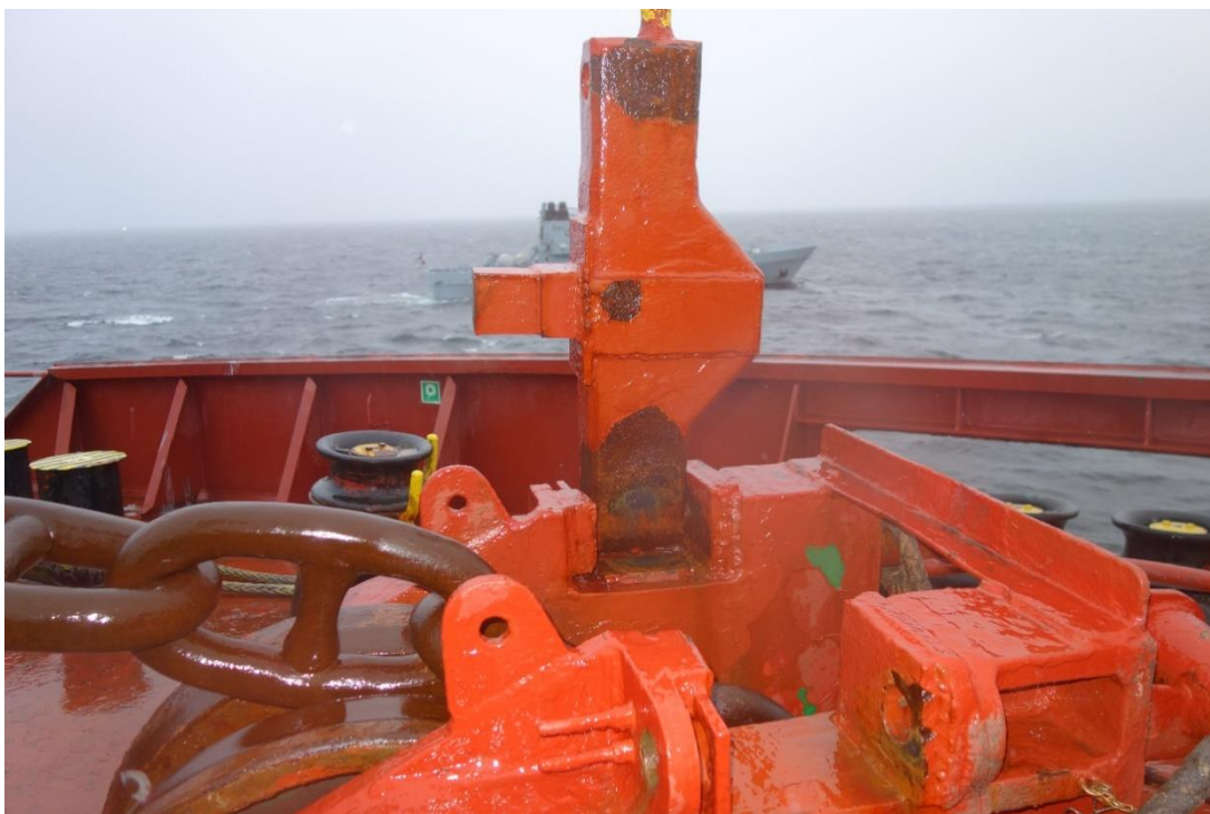
Figur 8. Babords kättingstoppare i öppet läge.
