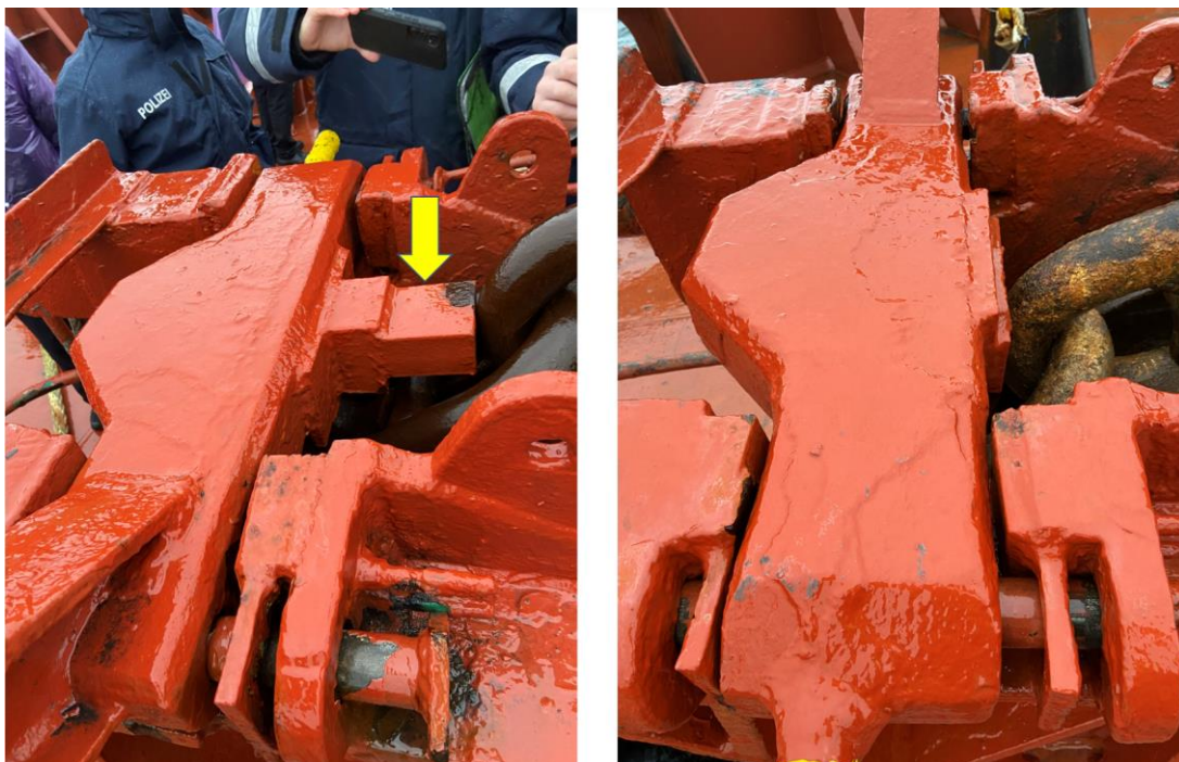
Figur 7. De båda kättingstopparna, babord till vänster. Den gula pilen markerar den långa påsvetsade stopplacken.
