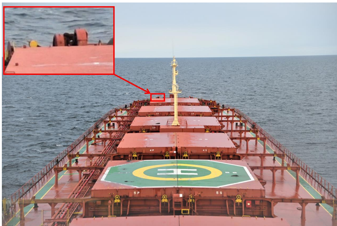
Figur 3. Vy från bryggan. Förstoringen visar babords ankarspel med kättingbjörnens motvikt målad i gult.
