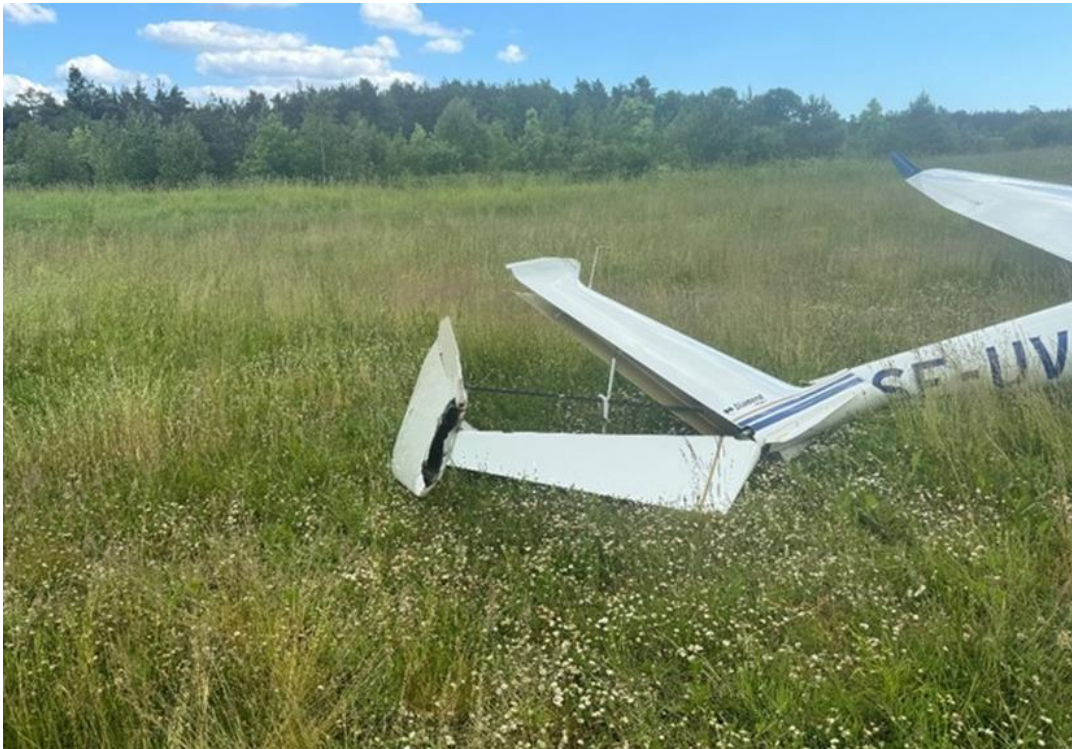
Figur 10. Bild på avsliten stabilisator och sidroder.
