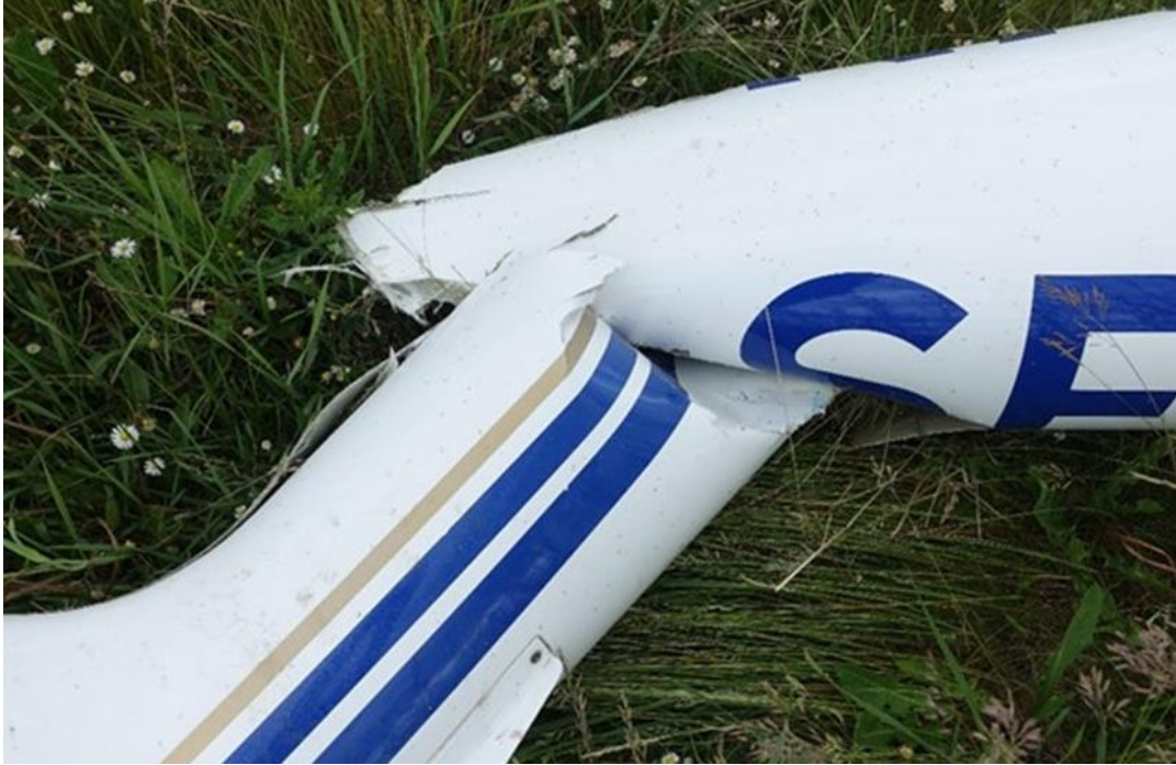
Figur 9. Bild på den avbrutna bakkroppen.
