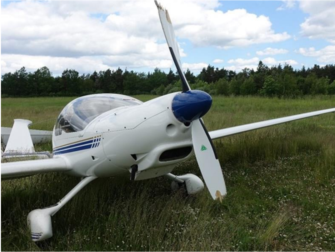
Figur 8. Bild på propellerbladen med avbrutna spetsar.
